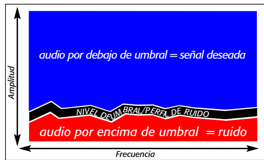
Este diagrama ilustra una configuración baja de Noise Tuner (Sintonizador de ruido). Un perfil de ruido personalizado es el resultado de haber usado la función Learn Noise (Aprender ruido). Varias
