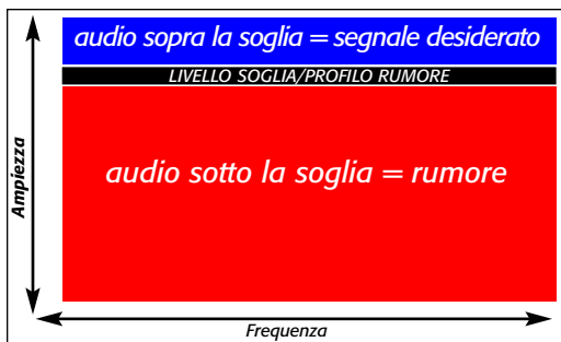
In questo diagramma è illustrata un'impostazione alta di Noise Tuner (Sintonizzatore rumore), con un profilo del rumore piatto. In questo esempio tutte le frequenze sono interessate nello stesso modo.
