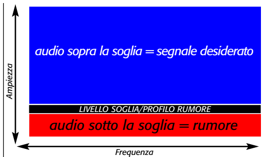
In questo diagramma è illustrata un'impostazione bassa di Noise Tuner (Sintonizzatore rumore), con un profilo del rumore piatto. In questo esempio tutte le frequenze sono interessate nello stesso modo.
