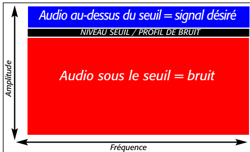
Ce schéma illustre un réglage élevé de Noise Tuner mais avec un profil de bruit neutre – dans cet exemple, toutes les fréquences sont traitées identiquement.
